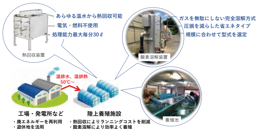
養殖場に設置された、高濃度酸素溶解装置
